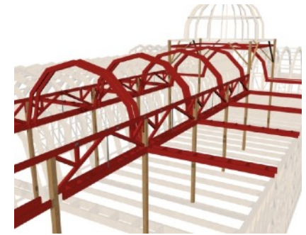
Estabilización de Vigas Interiores y estructura en Techo
